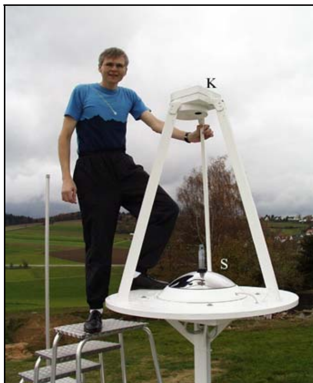
Der technische Leiter des Feuerkugelnetzes Dieter Heinlein mit der Meteoritenkamera Nr. 45 Streithelm. Über dem 36 cm durchmessenden Spiegel (S) befindet sich die Kamera (K).
